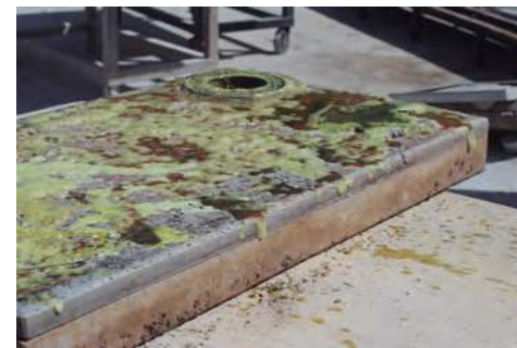
02 Aplicación de ácido |
